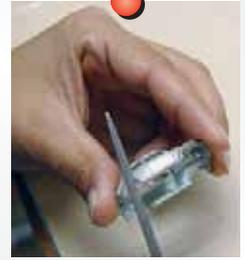
Entfernen größerer Spritzgrate von Hand ...
