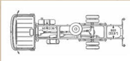
Durch Verstärkung des Fahrgestells, der Fahrzeugfedern und der Bereifung wurde die Nutzlast ab 1967 beim Typ Mercedes-Benz LP808 auf 4,5 Tonnen angehoben.
