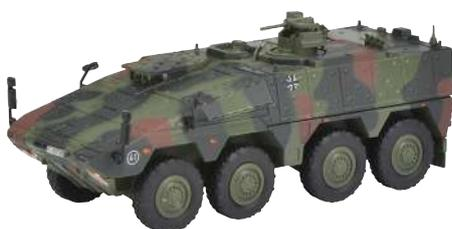
• Das GTK „Boxer“ ist ein von der deutschen Firma ARTEC GmbH entwickelter Radpanzer. Die Bezeichnung GTK steht hierbei für „gepanzertes Transport-Kraftfahrzeug“. Der 8-rädrige Boxer kann als Gruppentransportfahrzeug, Sanitätsfahrzeug und als Führungsfahrzeug eingesetzt werden. Eine Besonderheit des allradangetriebenen Fahrzeuges ist seine Modular-Bauweise.
