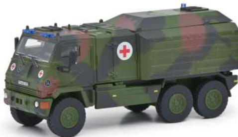
• Unter dem Namen Rheinmetall YAK ist das Fahrzeug bei der deutschen Bundeswehr als Truppentransporter, Feldjägerfahrzeug (Militärpolizei) und Ambulanz im Einsatz. Der YAK verfügt über ein in seiner Klasse bislang unerreicht hohes Niveau bezüglich Insassenschutz. Das Fahrzeug gewährleistet seiner Besatzung Schutz gegen ballistische Bedrohung und verfügt darüber hinaus über einen integrierten Minenschutz.
