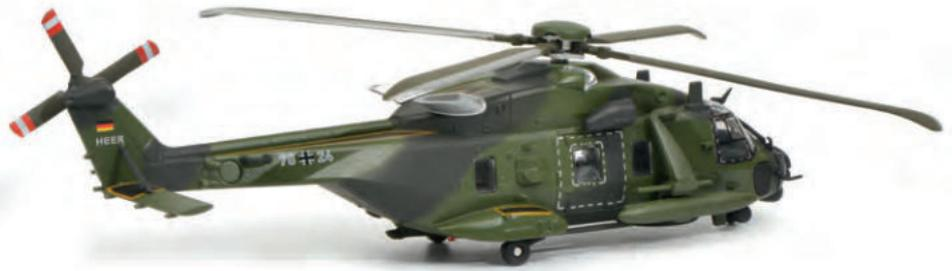
Der NH 90 (Nato Helicopter 90) wurde als leichter, allwettertauglicher und nachflugfähiger Mehrzweckhubschrauber entwickelt. Da der Rumpf größtenteils aus Faserverbundstoffen besteht, verfügt dieser Hubschrauber über einen weitaus geringeren Radarquerschnitt als andere Hubschrauber. Das Aufgabengebiet des NH 90 reicht als Mehrzweckhubschrauber vom Material- und Personaltransport über den Transport von Spezialkräften bis zur Evakuierung von Verletzten vom Gefechtsfeld.
